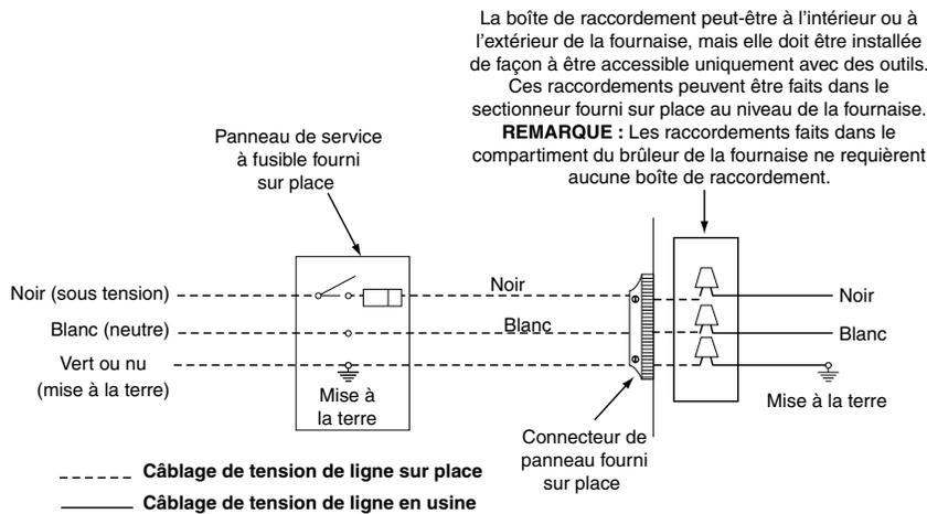
**Figure 25. Câblage d'excitation de tension de ligne**
