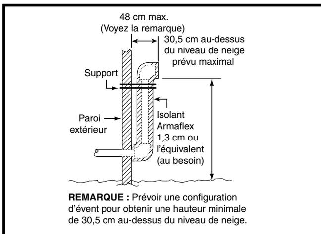
**Figure 3. Autre installation d'un conduit d'évent horizontal**
