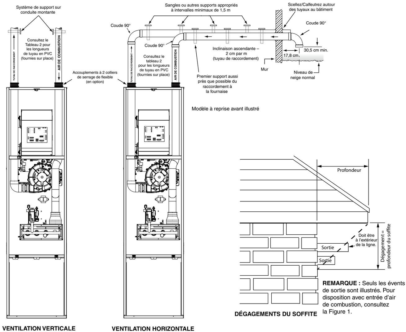
Figure 29. Évacuation horizontale/verticale et dégagements du soffite
