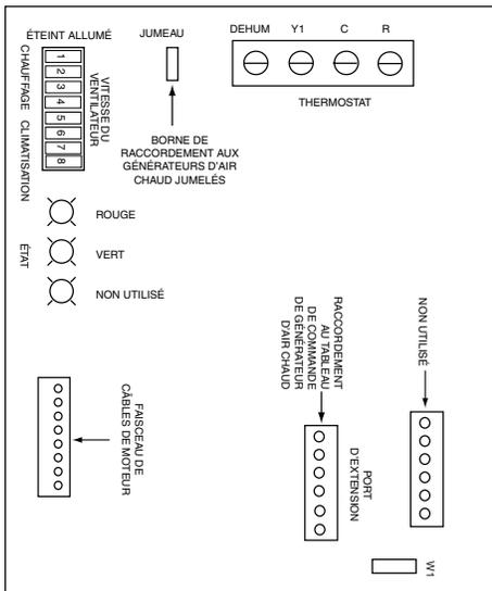
**Figure 26. Tableau de commande de moteur MG2S**
