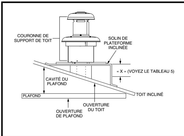
Figure 18. Exemple de support plat avec solin
