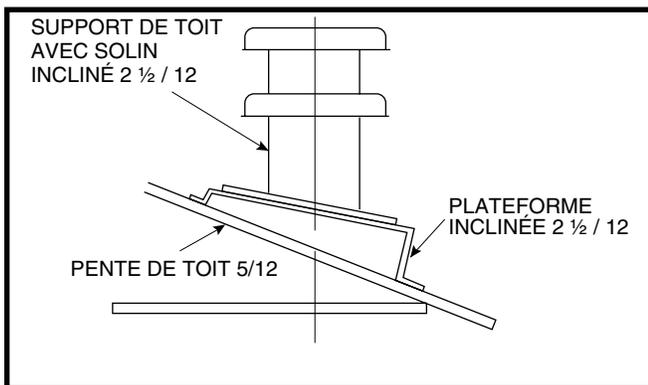
Figure 19. Exemple de support de toit 2 1/2 / 12 avec solin
