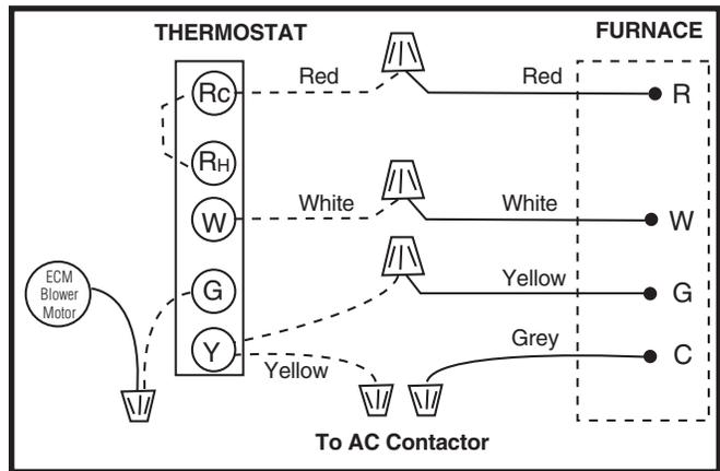
**Figure 25. Thermostat Wiring**
