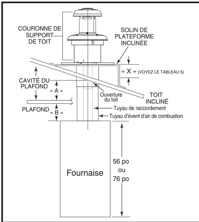
Figure 17. Profondeur de la cavité du plafond
