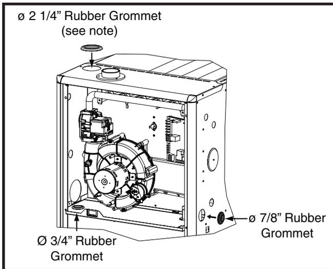
**Figure 19. Rubber Grommets**
