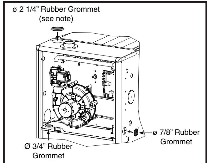
**Figure 18. Rubber Grommets**
