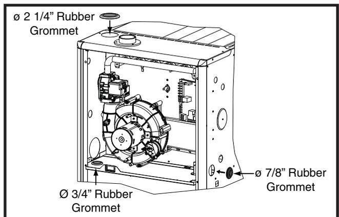
Figure 21. Rubber Grommets
