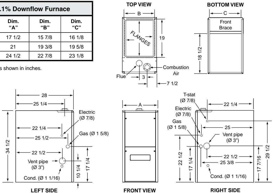
**Figure 28. Furnace Dimensions**
