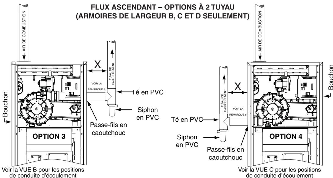
Figure 39. Options de ventilation à flux ascendant (armoires de largeur B, C et D)
