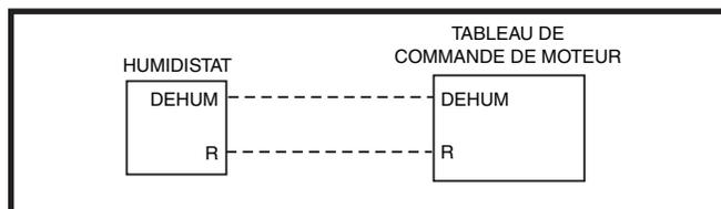
**Figure 25. Configuration de câblage DEHUM avec humidistat**
