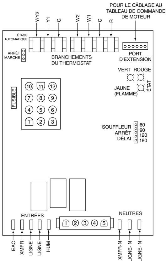
Figure 30. Tableau de commande de générateur d'air chaud à deux étages
