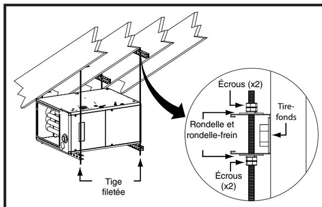
Figure 12. \*TC suspendu à l'horizontale dans un comble
