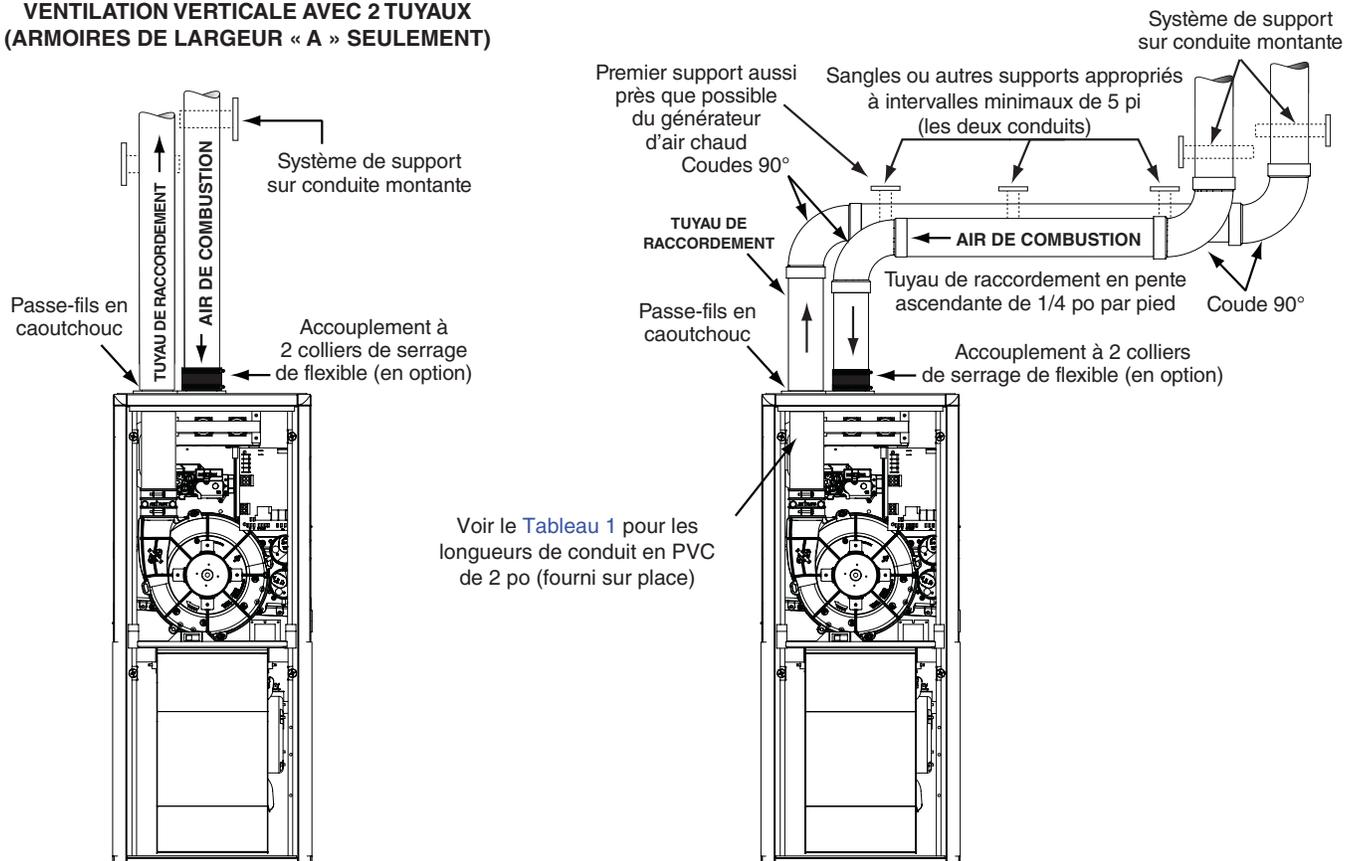
**Figure 36. Ventilation horizontale et ventilation verticale (cabinets de largeur A)**
