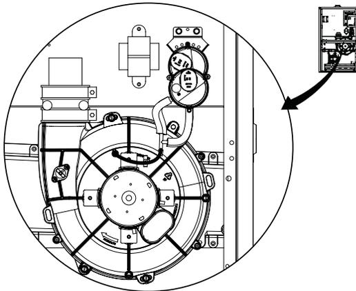
**Figure 15. Tube de pressostat pour générateurs d'air chaud à flux descendant \*TL**
