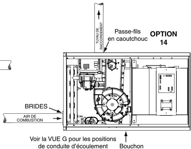
**Figure 41. Options de ventilation horizontale (armoires de largeur B, C et D)**
