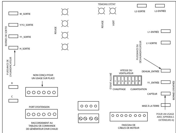
Figure 31. Tableau de commande de moteur à vitesse variable à deux étages
