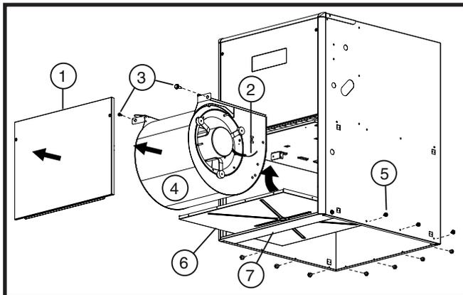
Figure 18. Désassemblage du panneau inférieur
