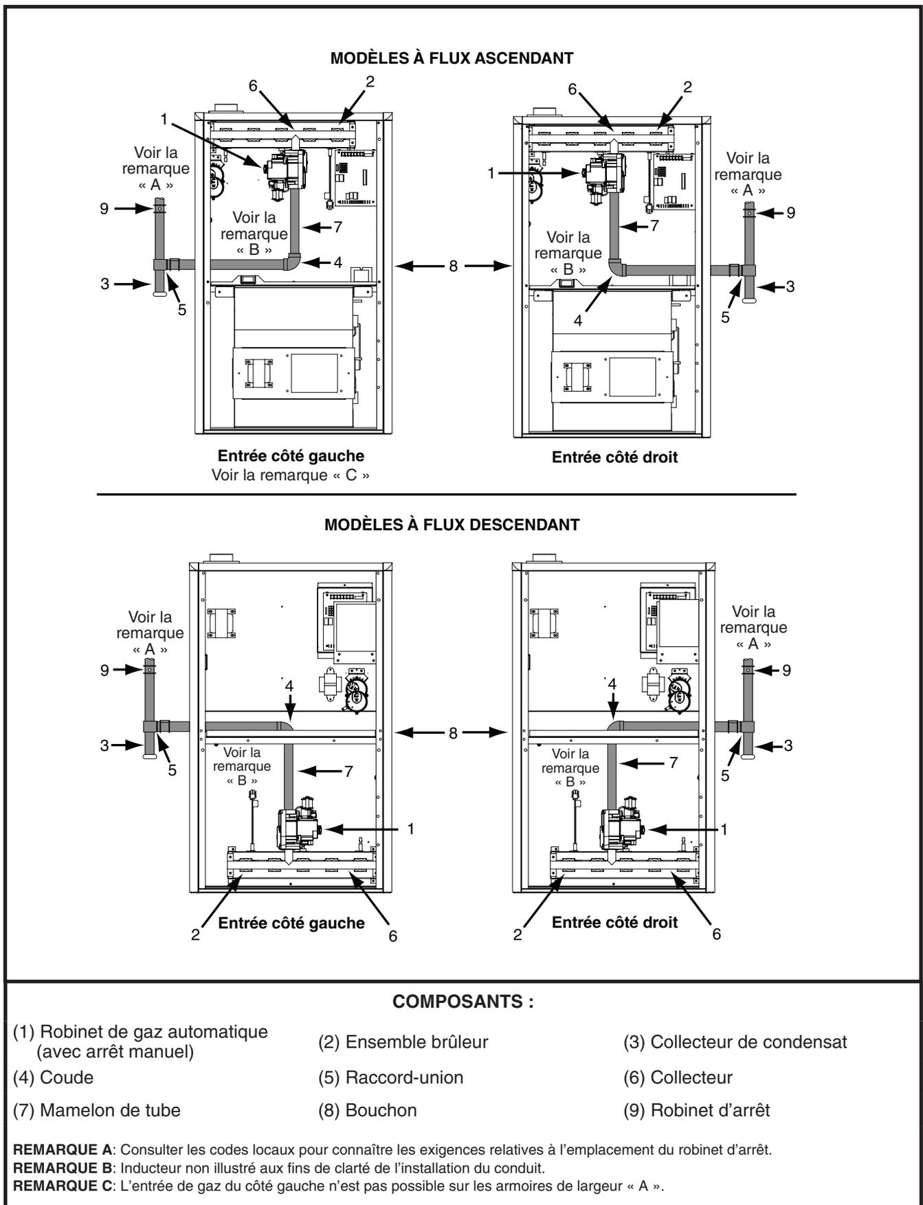
**Figure 20. Raccordements de gaz typiques**
