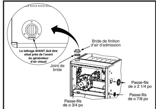
**Figure 16. Bride de finition et passe-fils en caoutchouc**
