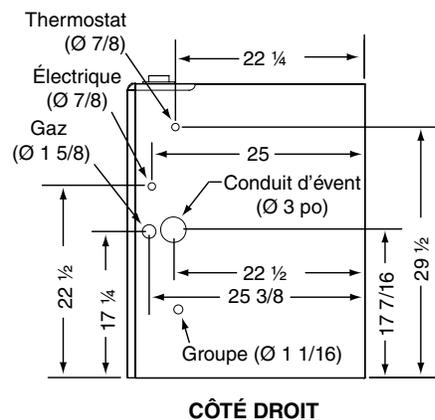
Figure 28. Dimensions des armoires \*TC et \*TL
