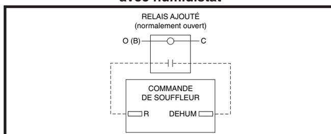
**Figure 26. Configuration de câblage DEHUM sans humidistat**
