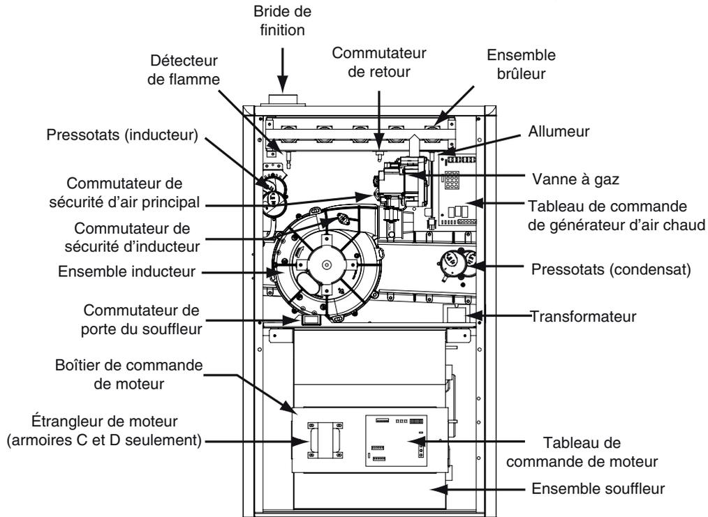
**REMARQUE :** L'emplacement des composantes peut être différent dans les armoires de largeur « A ».
