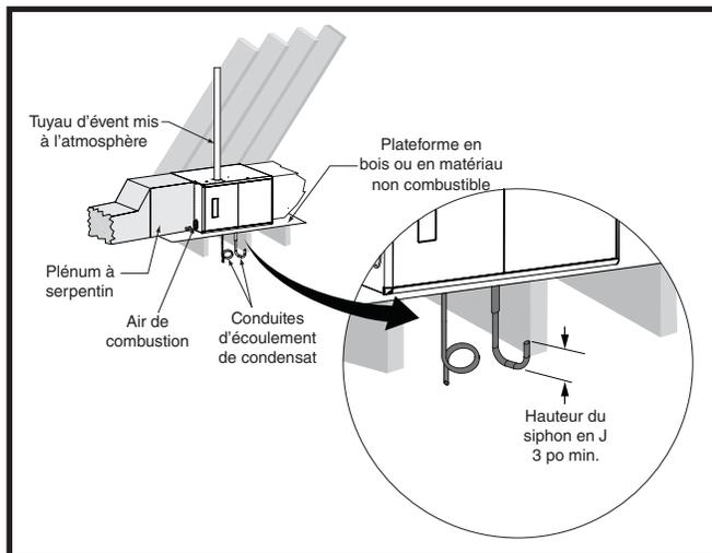
Figure 11. \*TC installé à l'horizontale sur une plate-forme
