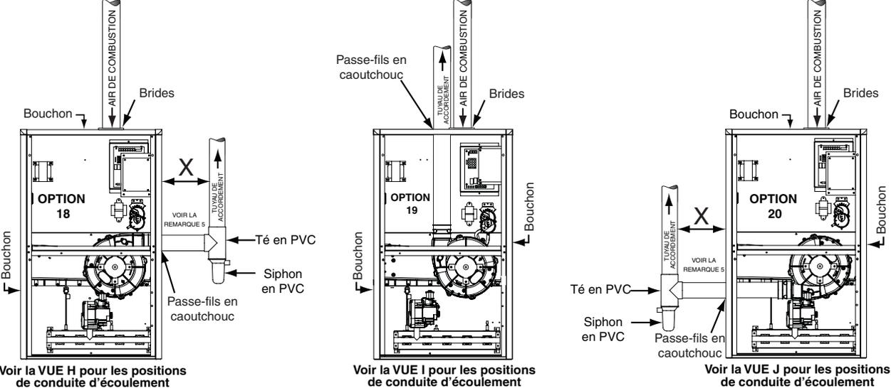
Voir la VUE H pour les positions de conduite d'écoulement
