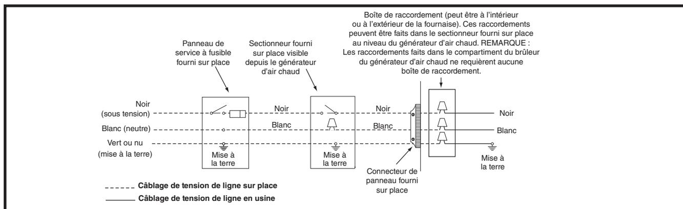
**Figure 21. Câblage de tension de ligne sur place**
