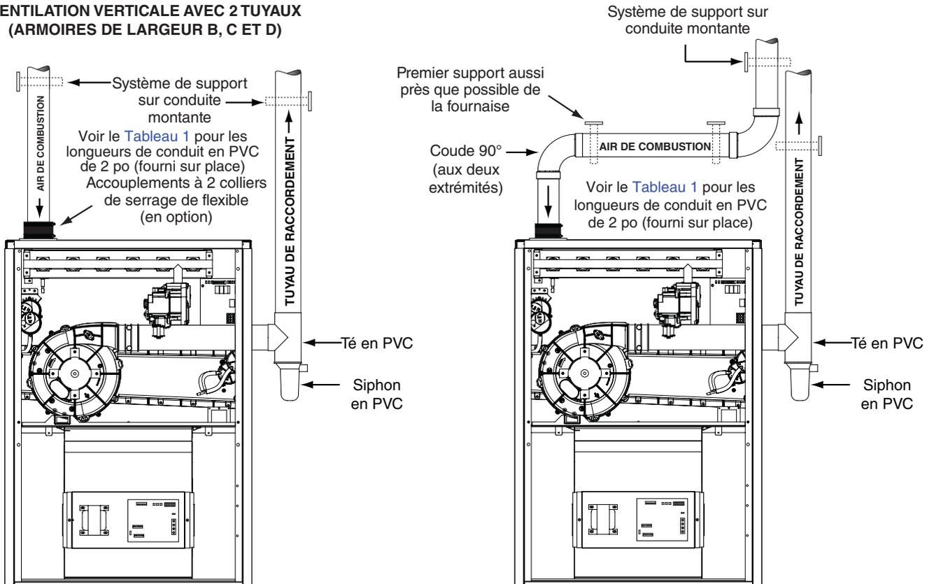
**Figure 37. Ventilation horizontale et ventilation verticale (cabinets de largeur B, C et D)**
