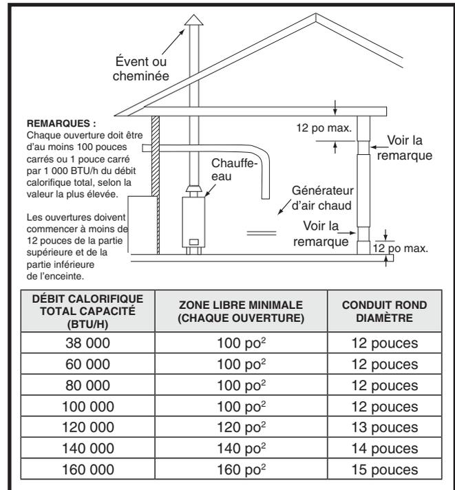
Figure 2. Air de combustion provenant de l'intérieur
