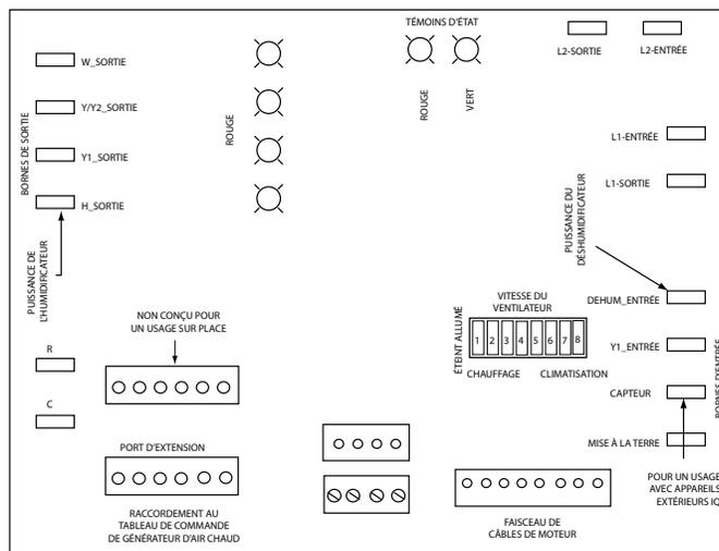
Figure 31. Tableau de commande de moteur à vitesse variable à deux étages
