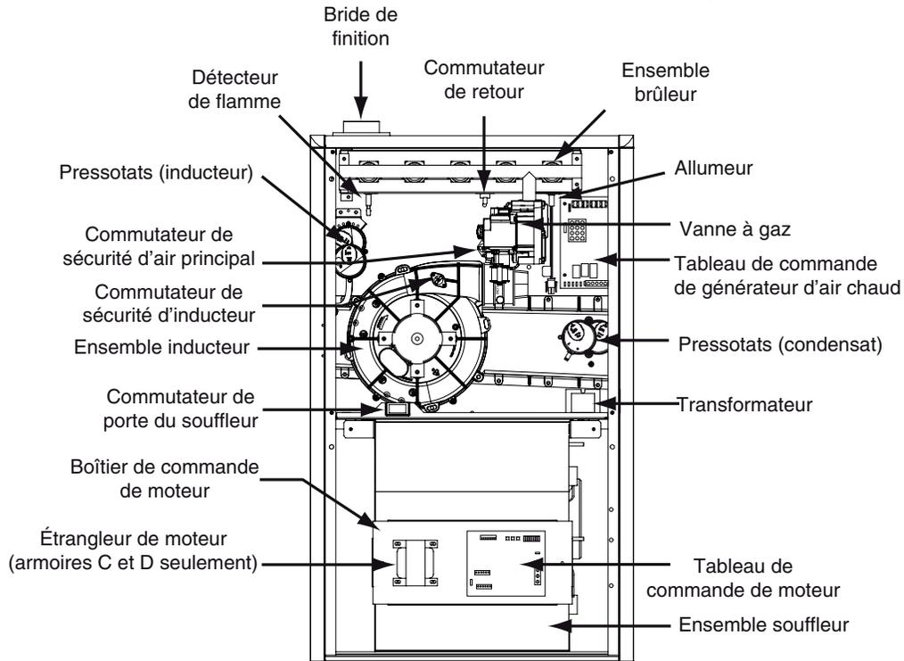
**REMARQUE :** L'emplacement des composants peut être différent dans les armoires de largeur « A ».
