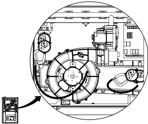
**Figure 14. Tube de pressostat pour générateurs d'air chaud à flux ascendant/horizontaux \*TC**
