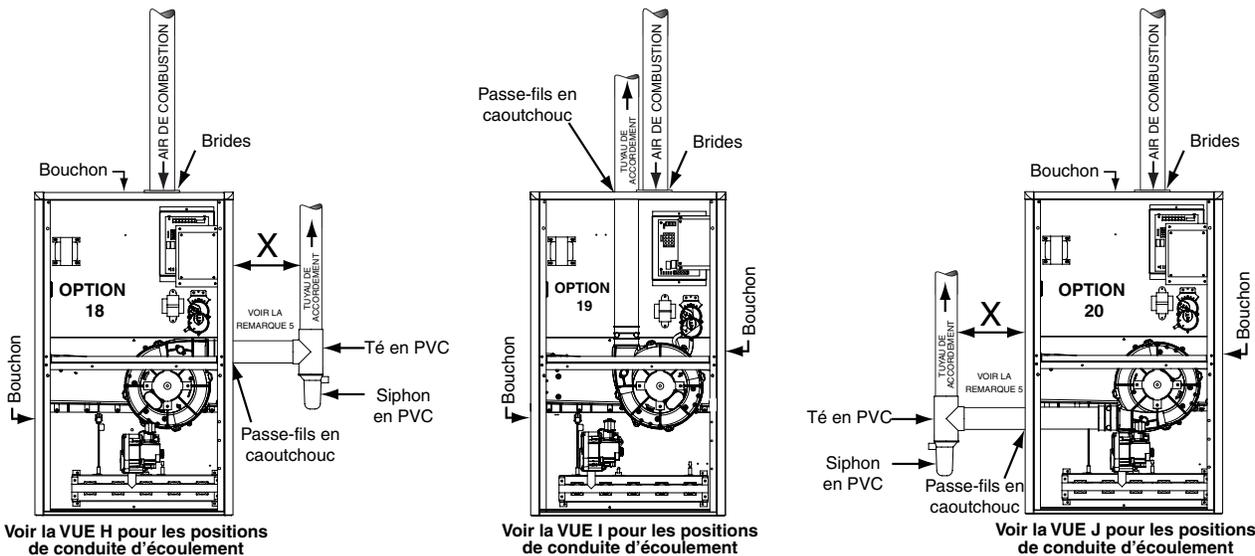
Voir la VUE H pour les positions de conduite d'écoulement
