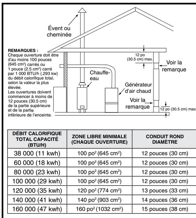
Figure 2. Air de combustion provenant de l'intérieur
