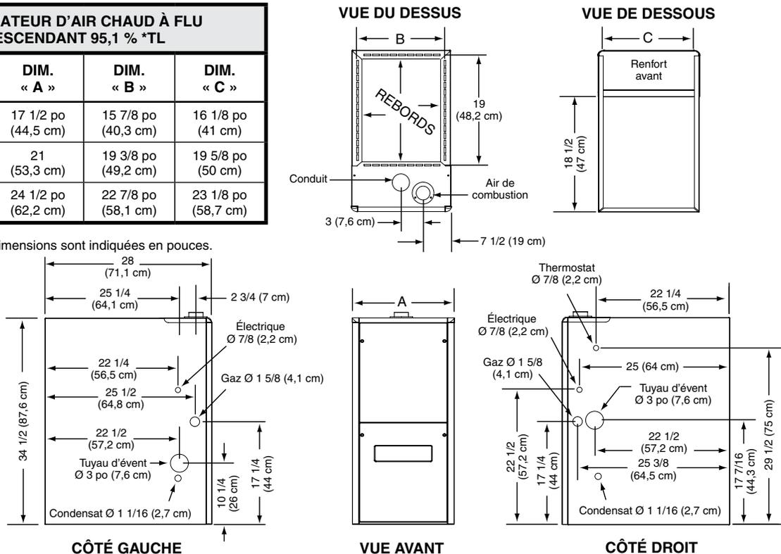
Figure 28. Dimensions des armoires \*TC et \*TL
