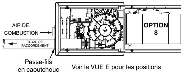
Voir la VUE E pour les positions de conduite d'écoulement
