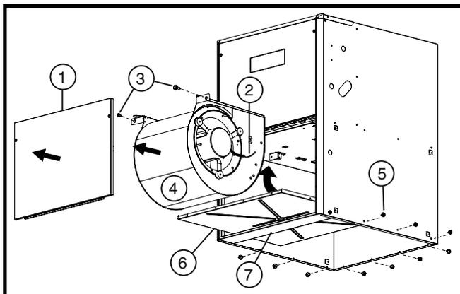
**Figure 18. Désassemblage du panneau inférieur**
